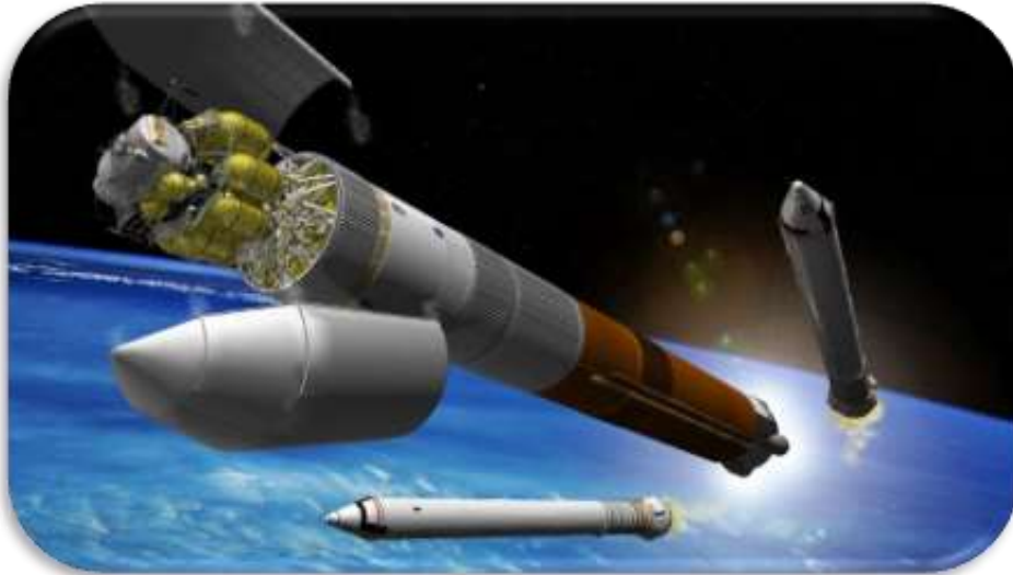
Figura 19. Separación etapas (Créditos: spacex )
