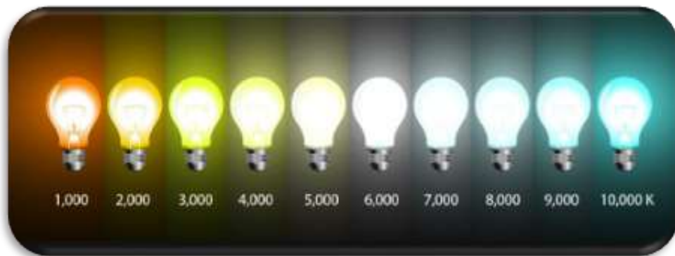
Figura 4: Colores de las bombillas en función de su temperatura. (Créditos: https://rec-line.com/blog/como-elegir-la-tonalidad-de-luz-de-bombillas-led/ )
