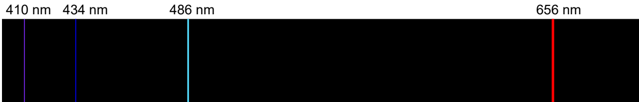
Fig 7. Líneas visibles de emisión del Hidrógenos en las series de Balmer. Fuente: Wikimedia.org
